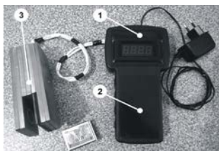
Рисунок 8 – Общий вид электротехнического устройства контроля рН: 1 – блок индикации; 2 – автогенераторный измерительный преобразователь; 3 – первичный преобразователь
