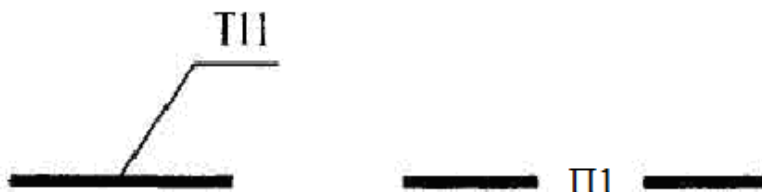
Рисунок 6 Буквенно-цифровое обозначение трубопроводов или воздуховодов
